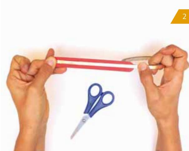
Wir schneiden das Kupferklebeband zwei Mal auf die Länge des Holzspatels zu, sodass beide Seiten des Spatels damit im Anschluss beklebt werden können. Dabei sollte darauf geachtet werden, dass die beiden Streifen des Kupferklebebands nicht über den Rand hinausragen und sich nicht berühren.
